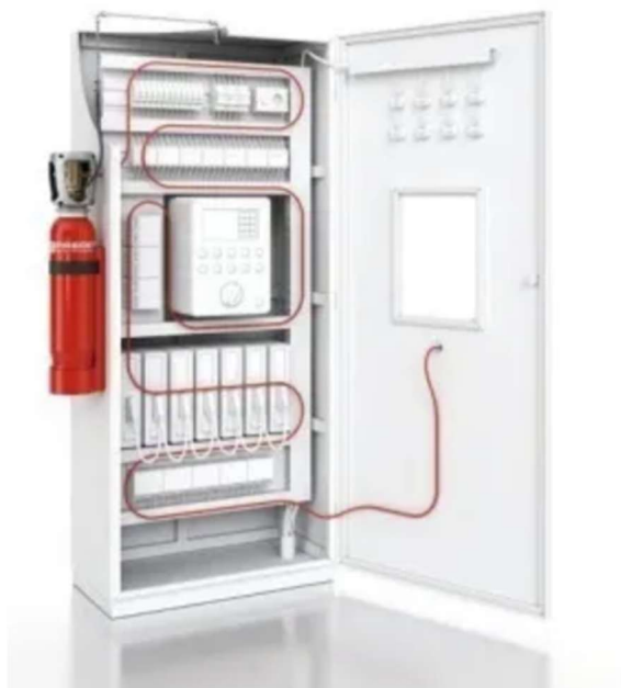
Kuva 1, Automaattinen kohdekohtainen sammutusjärjestelmä esimerkkikuva, kohteen sisäisellä muoviputkituksella, joka sulaessaan laukaisee paineistetun pullon sisällön sammutettavan kohteen sisälle (tämä on yksi käytössä olevista laukaisumenetelmistä).
